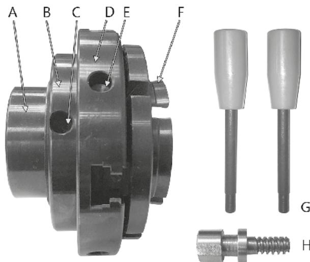
A – хвостовик, B – корпус, C, E – отверстие для ключа, D – фланец, F – кулачки, G – ключи, H – вставка винтовая
